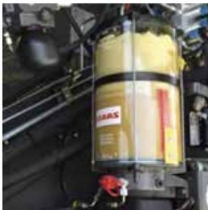
**Graissage centralisé 2-TRAC**
